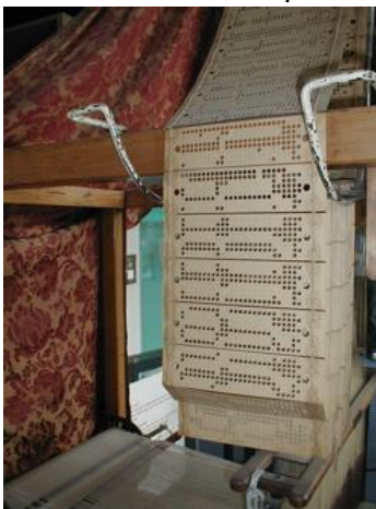
Tarjetas perforadas en un Telar de Jacquard.
